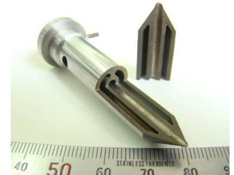
従来工法では加工し得なかった冷却回路を内蔵させて、冷却効率の向上を図る。
